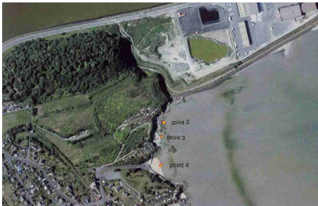
Figure 43 : Points d'analyses granulométriques sur la zone de recharge ( point 2 et 3) et la plage du Valais (point 4)
