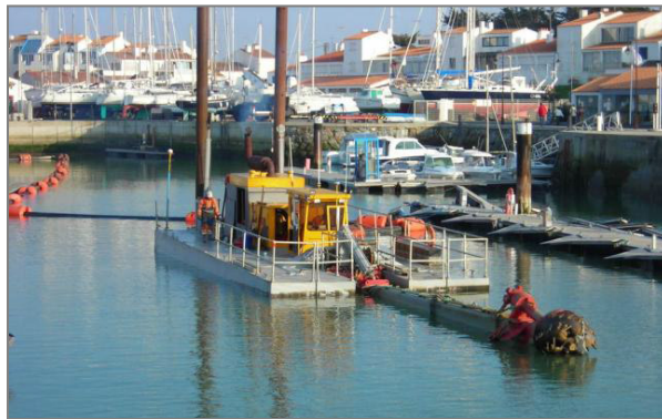
Figure 23 : Drague aspiratrice stationnaire et son élinde (IDRA)
