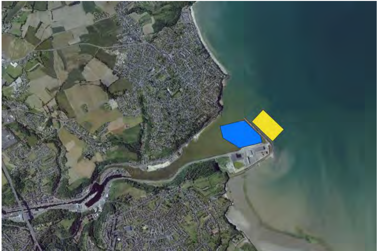
Figure 1-2. Port du Légué et localisation des zones de dragage dans l'avant-port (bleu) et de dépôt derrière la digue (jaune)
